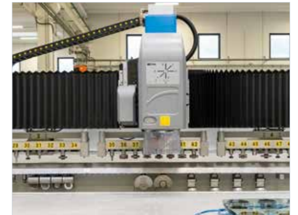
Cargador de herramientas debajo del travesaño con hasta 24 posiciones de los conos.
