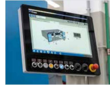
L'unité de contrôle est intégrée à la machine et l'écran de 21,5" avec commande tactile permet de profiter pleinement de la nouvelle interface homme-machine. L'opérateur est guidé en permanence lors des opérations de fonctionnement de la machine les plus courantes.
