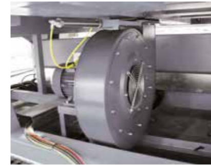
Die Arbeitsplatte besitzt ein Luftkissensystem, das je nach Größe und Gewicht der Glasscheibe auf zwei Niveaus eingestellt werden kann
