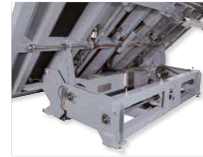
Système pendulaire mécanique. La sortie automatique des pieds est commandée pendant la rotation de la table d'usinage
