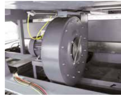
La table d'usinage est équipée d'un système à coussin d'air réglable sur 2 niveaux, en fonction des dimensions et du poids de la plaque de verre
