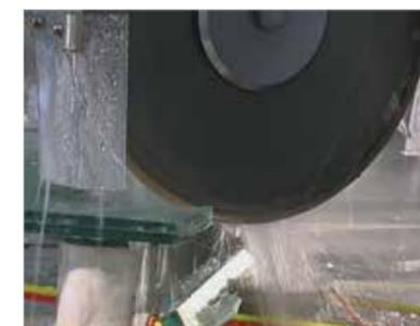
由于主轴的动力,可以安装切割圆盘以消除多余的材料。特别适用于在夹层玻璃上加工复杂的几何形状。
