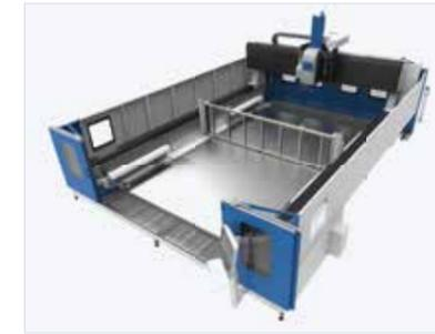
配有双工作台面的版本。机床还可以设置在交替模式下进行加工，并为操作员提供全面的安全性。如有必要，可移除分隔两个区域的隔板，从而可以使用尺寸更大的工作台。
