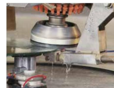
N.T.S.(非模板系统)是一种革命性的系统,可在薄玻璃上进行斜切,而无需求助于创建模板。与加工头一体的支架在斜切过程中支撑玻璃,这样最终的结果是沿着整块板材进行均匀的加工。
