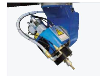
5轴头允许您不受限制地执行任何类型的加工。可以在不使用任何聚合体的情况下进行斜切磨削或杯形磨削。
