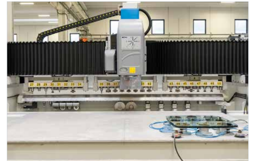
Werkzeughalter unter dem Träger mit bis zu 24 Kegelpositionen
