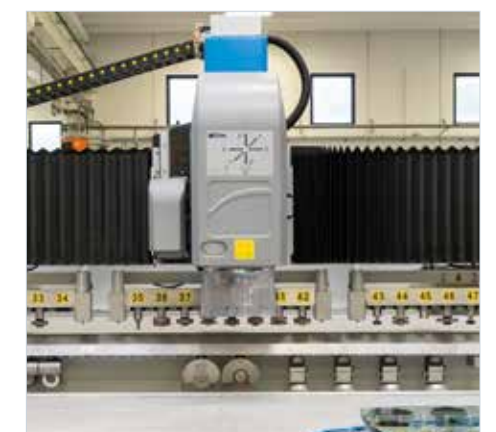
Werkzeughalter unter dem Träger mit bis zu 24 Kegelpositionen
