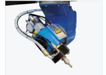
La tête 5 axes permet de réaliser tous types d'usinage sans limites. Biseautage ou meulage à tasse peuvent être réalisés sans ajout d'agrégats.
