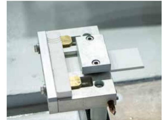
Grâce au dispositif, il est possible d'aiguiser les meules diamantées de manière entièrement automatique selon une fréquence préétablie. Ce système automatique permet d'avoir des outils qui réalisent un usinage, totalement sûr, au maximum des performances de la machine.
