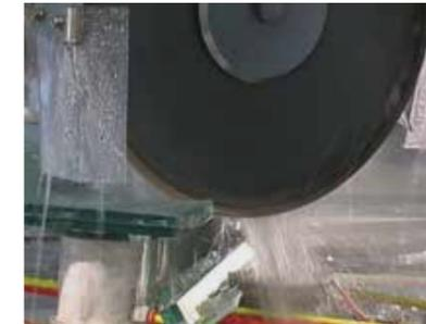
Grâce à la puissance de l'électrobroche, il est possible de monter des disques de découpe pour éliminer le surplus de matière. Particulièrement indiqué pour l'élaboration de géométrie complexe sur des plaques de verre laminées.
