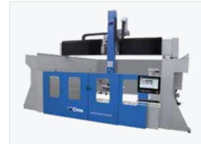
Grâce aux portes avant télescopiques, l'opérateur travaille dans un environnement complètement protégé. De plus, les portes garantissent une parfaite retenue de l'eau à l'intérieur de la machine.
