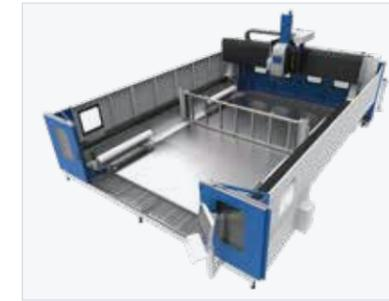
Version avec double table d'usinage. La machine peut aussi être configurée pour l'usinage en mode pendulaire et en toute sécurité pour l'opérateur. Si besoin, il est possible de retirer la cloison qui sépare les 2 zones de travail pour avoir une table de grandes dimensions.
