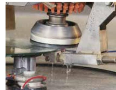
N.T.S. (No Template System) èst un système révolutionnaire qui permet de biseauter de fines plaques de verre sans devoir créer de gabarit. Un support solidaire à la tête d'usinage soutient le verre pendant le biseautage. Il en résulte un usinage uniforme sur toute la plaque.
