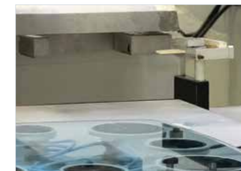
Presetting laser integrado no armazém para não perder espaço útil de trabalho na tábua. Avivador de utensílios diamantados e polidores para utensílios sempre no máximo dos desempenhos
