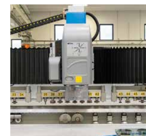
Расположенный под траверсой магазин инструментов на 24 позиции
