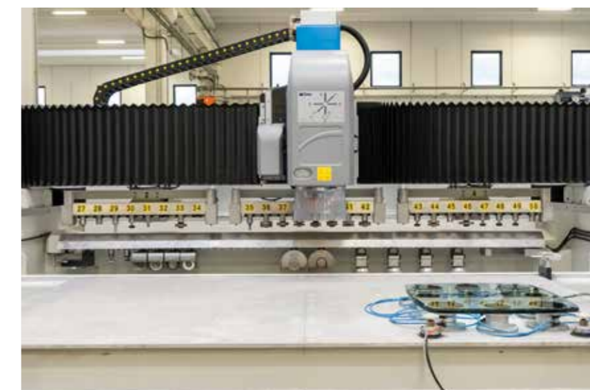
Расположенный под траверсой магазин инструментов на 24 позиции
