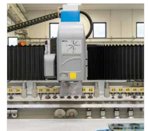
Cargador de herramientas debajo del travesaño con hasta 24 posiciones de los conos.
