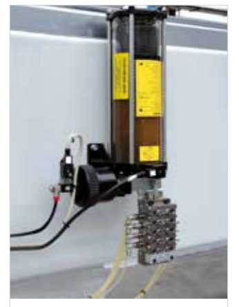
Sistema de lubricación automático.
