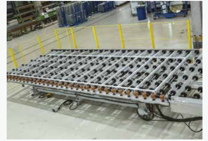
机动辊道和加载台 (可倾斜)
