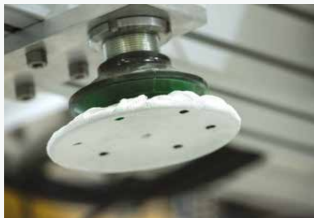
Присоски для манипулирования низкоэмиссионным стеклом
