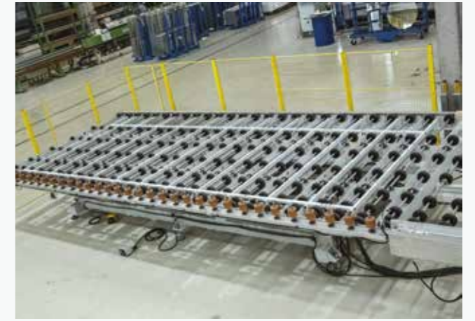
Моторизованные роликовые конвейеры и загрузочные столы (опрокидывные)
