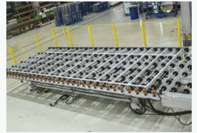
Mesas de rodillos motorizadas y mesas de carga (plegables)
