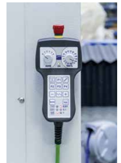
Botonera remoto para controlar hasta 6 ejes que permite operar cerca del plano de corte y establecer múltiples orígenes
