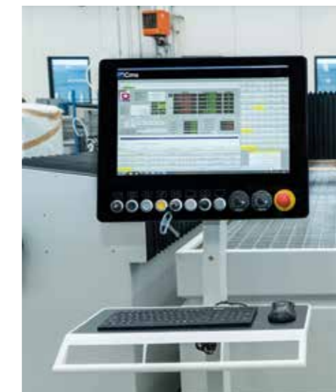
Consola sobre carro móvil con pantalla táctil de 21,5"
