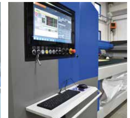
PC Panel industrial de 21,5" a bordo de la máquina con display táctil e interfaz HMI CMS Active
