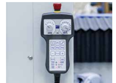
Botonera remoto para controlar hasta 6 ejes que permite operar cerca del plano de corte y configurar múltiples orígenes (opcional)
