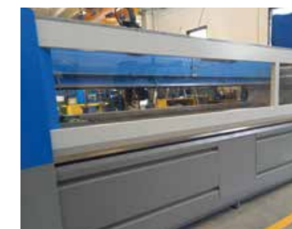
Puerta delantera y trasera con movimiento neumático para una mejor protección de la zona de corte y contención de las reverberaciones de agua y abrasivas
