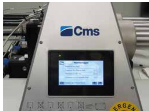
电子控制切割压力
