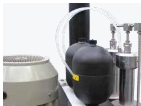
氮气蓄能器，用于管理液压缸回流管路
