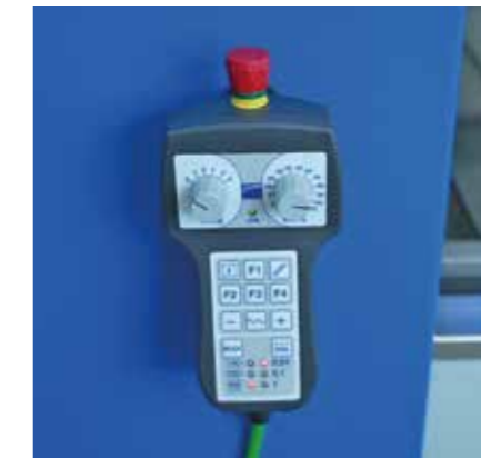
最多可控制6轴的远程按键板，允许靠近切割台操作并设置多个原点。
