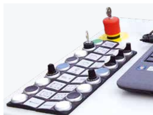
由控制台直接管理增压器的压力和运行控制
