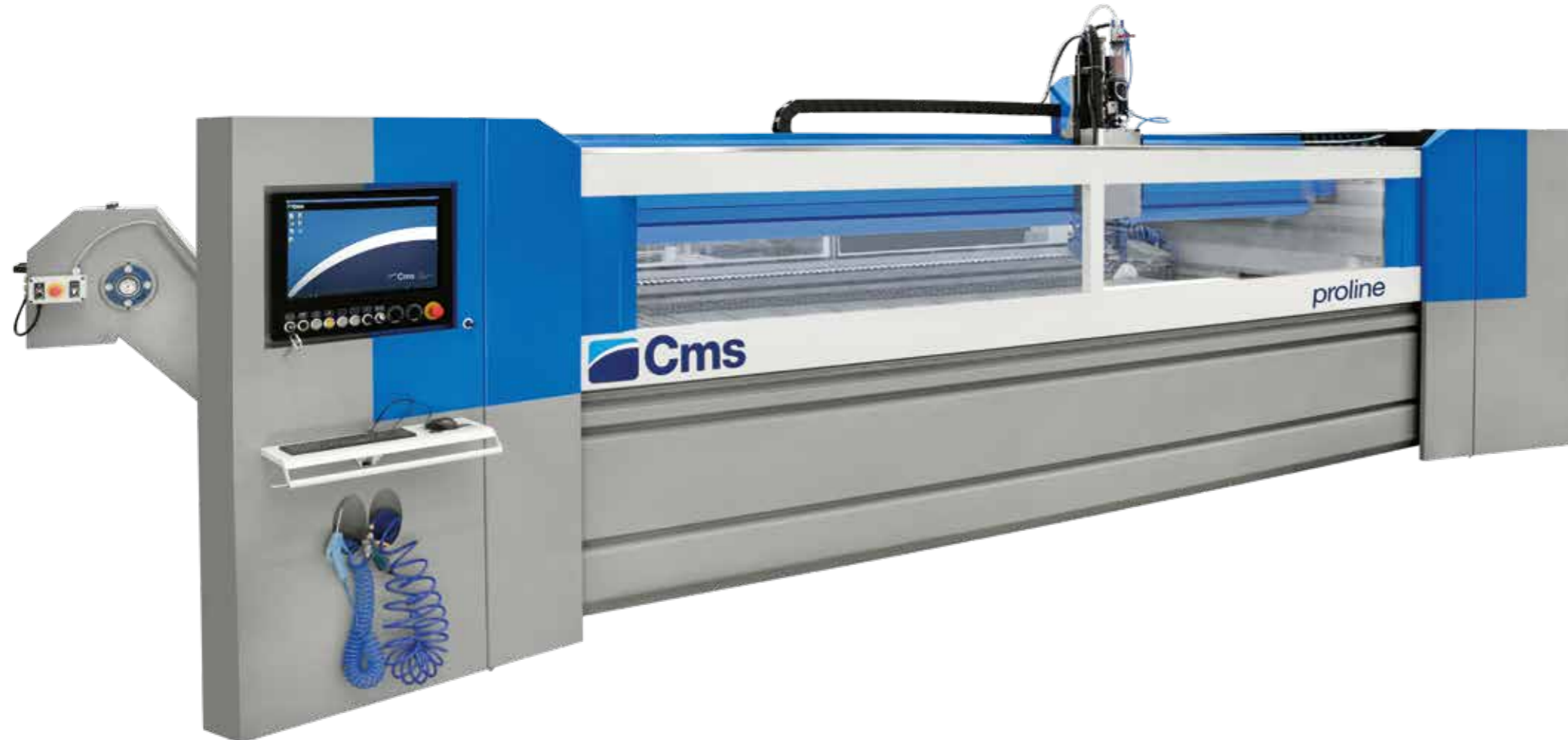
最多可控制6轴的远程按键板，允许靠近切割台操作并设置多个原点。
