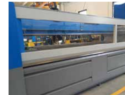
气控移动的前后门板可更好地保护切割区域并遏制水流与磨料反射。
