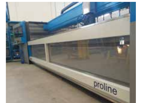
气控移动的前后门板可更好地保护切割区域并遏制水流与磨料反射。
