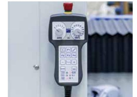
Fernbedienfeld für die Steuerung von bis zu 6 Achsen, für die Arbeit in der Nähe des Schneidtisches und die Einstellung von Mehrfachursprungspunkten (optional)
