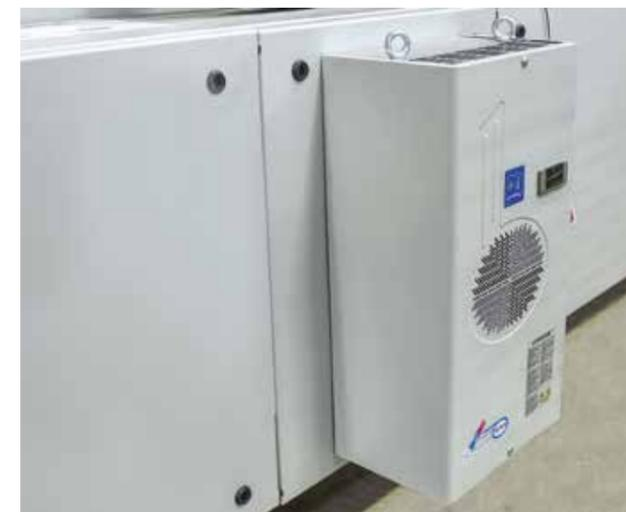
Klimaanlage für den Schaltschrank des Schneidtisches für Umgebungstemperaturen zwischen 35 °C und 40 °C.
