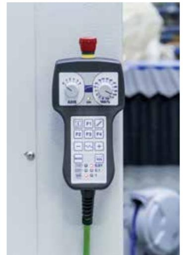
Fernbedienfeld für die Steuerung von bis zu 6 Achsen, für die Arbeit in der Nähe des Schneidtisches und die Einstellung von Mehrfachsprungpunkten.
