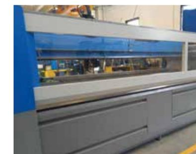
Vordere und hintere Klappe mit pneumatischer Bewegung für den besseren Schutz des Schneidbereichs und die Eindämmung von Wasser- und Schleifmittelspritzern.
