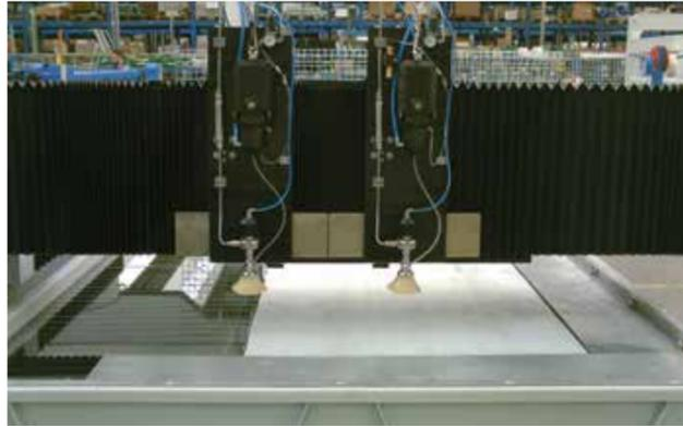
Zusätzliche Z-Achse zur Erhöhung der Schneidekapazität durch das gleichzeitige Schneiden mit zwei Schneidköpfen (3-Achsen). Reduzierung der X-Achse auf 1490 mm bei einem minimalen Abstand der Schneidköpfe von 510 mm.
