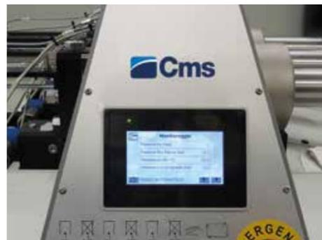
Elektronische Steuerung des Schneiddrucks
