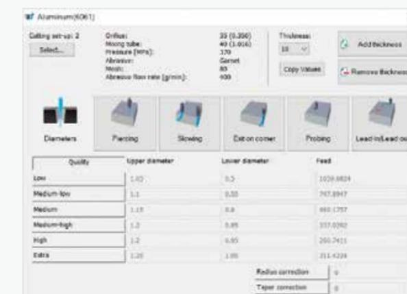
Im Paket enthalten ist das Plug-in JDE für die Steuerung der Schneidtechnologien, die in einer vollständigen Materialdatenbank archiviert sind. Das Maschinenprogramm wird automatisch auf Grundlage einer der 5 Schnittqualitäten (Q1, Q2, Q3, Q4 und Q5) generiert, die die Einstellungen der Vorschubgeschwindigkeit und der Beschleunigung in den Innen-/Außenecken festlegen. Das ISO-Programm kann dann über das lokale Netzwerk oder ein USB-Laufwerk auf die Maschine übertragen werden.
