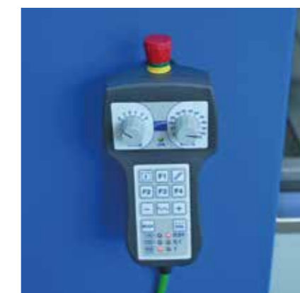
Panneau de commande à distance permettant de contrôler jusqu'à 6 axes pour travailler à proximité de la table de coupe et définir des origines multiples
