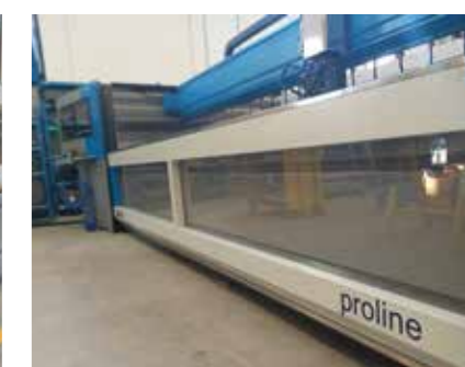
Porte avant et arrière avec mouvement pneumatique pour une meilleure protection de la zone de coupe et confinement de l'eau et des reflets abrasifs
