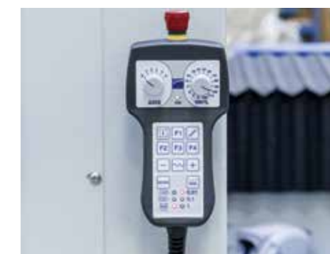
Panneau de commande à distance permettant de contrôler jusqu'à 6 axes pour travailler à proximité de la table de coupe et de définir des origines multiples (en option)
