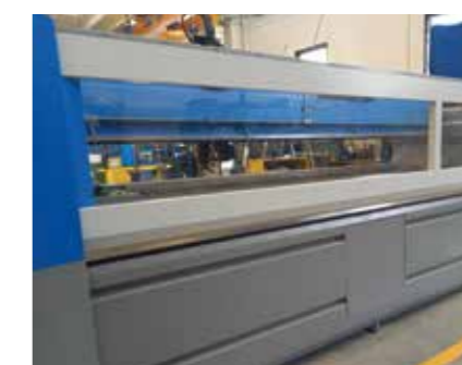
Porte avant et arrière avec mouvement pneumatique pour une meilleure protection de la zone de coupe et confinement de l'eau et des reflets abrasifs
