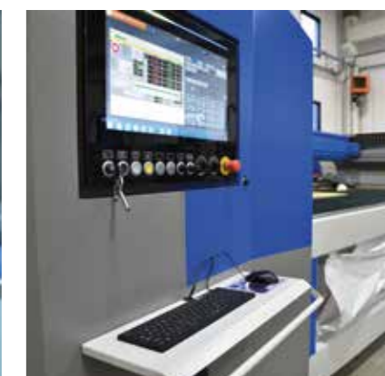
Panneau PC industriel 21,5" sur la machine avec écran tactile et interface HMI CMS Active
