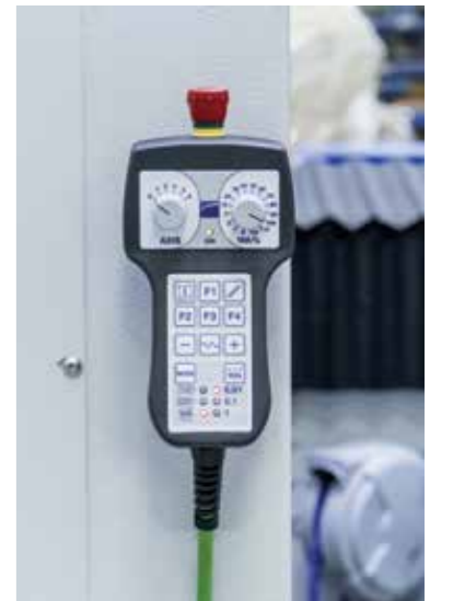
Panneau de commande à distance permettant de contrôler jusqu'à 6 axes pour travailler à proximité de la table de coupe et définir des origines multiples
