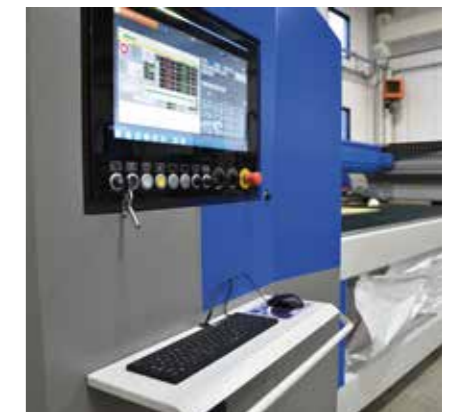
PC Panel industriale da 21,5" a bordo macchina con display touch e interfaccia HMI CMS Active.
