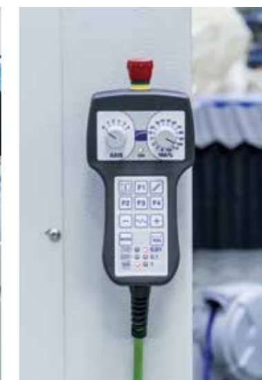
Pulsantiera remota per controllo fino a 6 assi che consente di operare vicino al piano di taglio e di impostare multiorigini.
