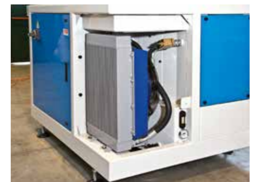
Scambiatore di calore aria/olio
