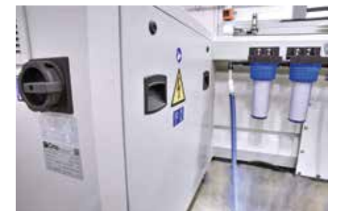
Quadro elettrico integrato al basamento della vasca per ridurre l'ingombro a terra.
