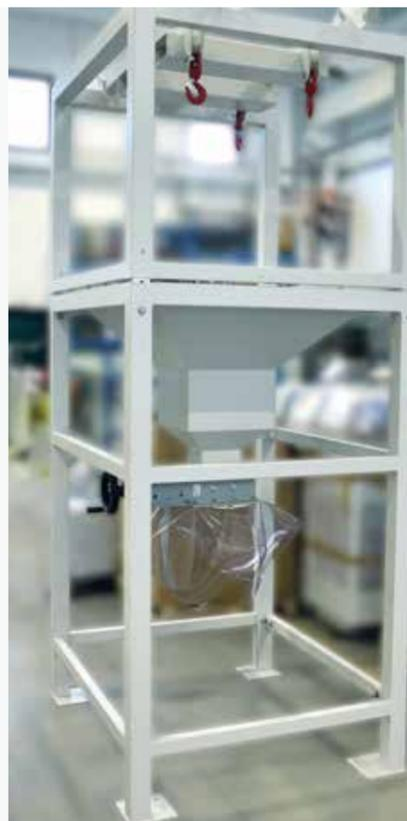
Двигатель абразива емкостью 330 кг для подачи абразива, оснащенный двумя баками: один емкостью 330 кг и другой, напорный, для подачи режущей головки (электронный дозатор). Также доступна двухступенчатая версия на 2000 кг, которая позволяет выполнять длительные работы без перерывов из-за отсутствия абразива с последующим повреждением материала..
