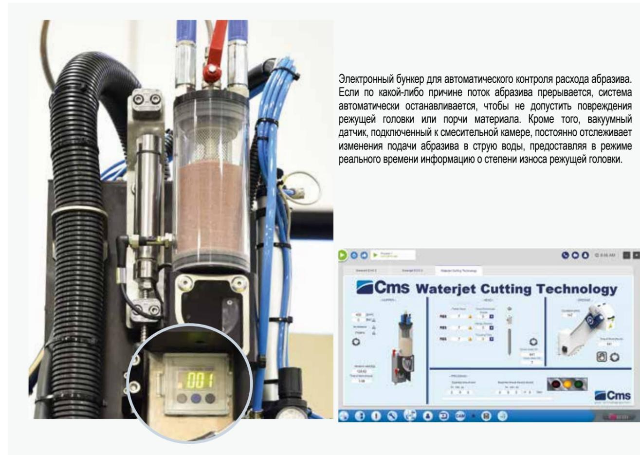
Электронный бункер для автоматического контроля расхода абразива. Если по какой-либо причине поток абразива прерывается, система автоматически останавливается, чтобы не допустить повреждения режущей головки или порчи материала. Кроме того, вакуумный датчик, подключенный к смесительной камере, постоянно отслеживает изменения подачи абразива в струю воды, предоставляя в режиме реального времени информацию о степени износа режущей головки.
