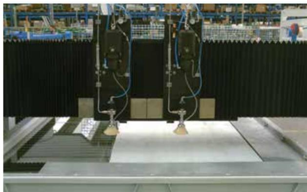
Дополнительная ось Z для настройки резки с двойной головкой по 3 осям для увеличения производительности за цикл. Ход оси X уменьшен до 1490 мм, чтобы обеспечить минимальное межосевое расстояние 510 мм.
