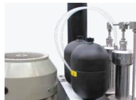
Аккумулятор азота для управления обратным контуром гидроцилиндров
