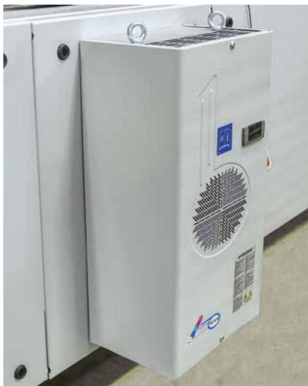
Кондиционер электрошкафа стола резки для температуры окружающей среды от 35°C до 40°C.
