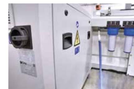
Электрическая панель встроена в основание резервуара для уменьшения занимаемой площади
