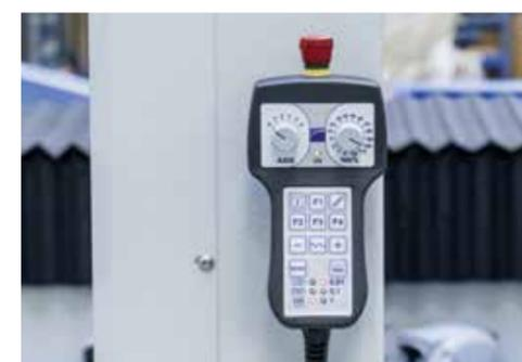
Выносной пульт для управления до 6 осями, позволяющий работать близко к плоскости резки и установить несколько исходных точек (опционально)
