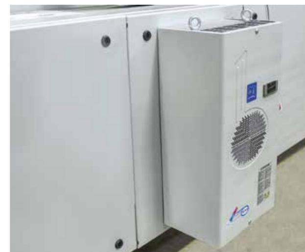
Кондиционер электрического шкафа стола резки для температуры окружающей среды от 35°C до 40°C.
