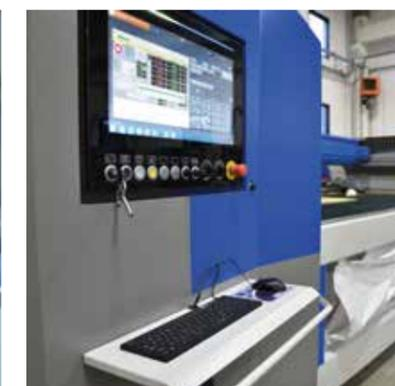
Промышленная панель ПК с диагональю 21,5 дюйма на борту машины с сенсорным дисплеем и интерфейсом CMS Active
