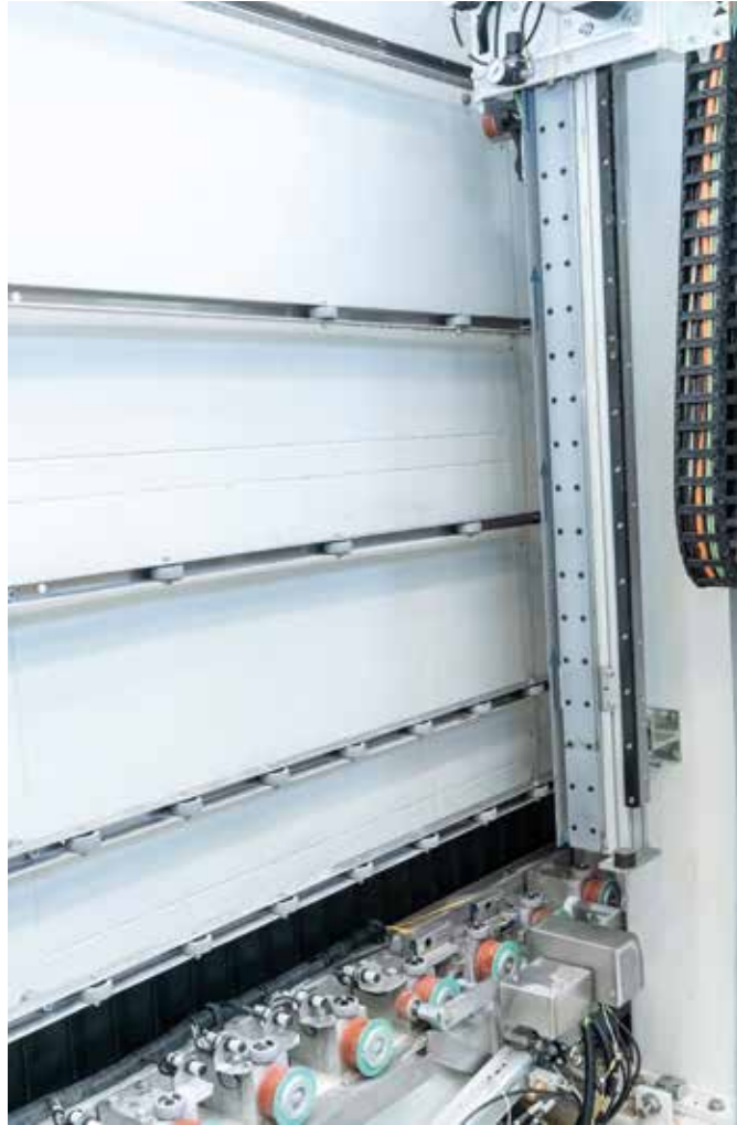
玻璃尺寸和倾斜度读取系统 自动读取玻璃板三个尺寸)，并测量其斜度
