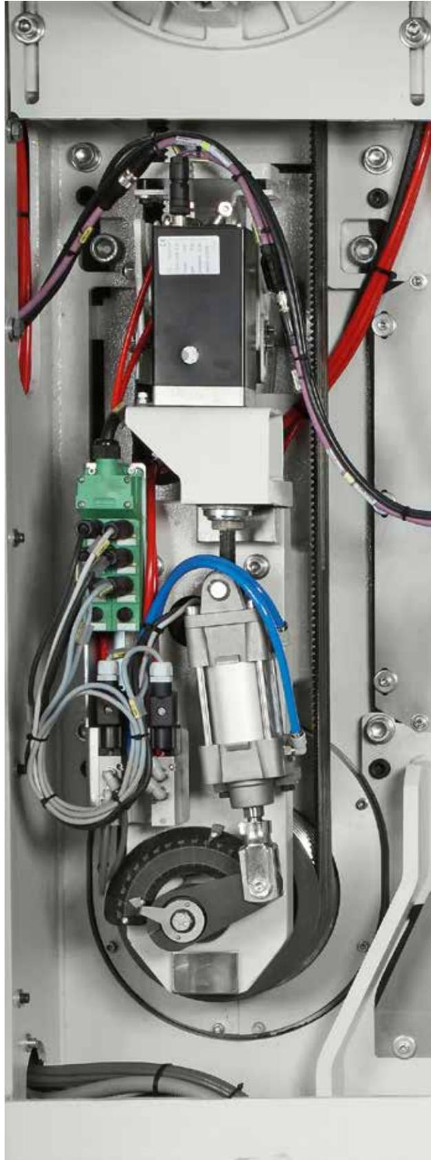
Die elektronische Einstellung der Arbeitsaggregate mit bürstenlosen Motoren, die von der SPS über eine CAN-BUS-Verbindung gesteuert werden. Damit können schnelle und punktgenaue Positionierungen der Aggregate und eine langfristig konstante Präzision gewährleistet werden.
