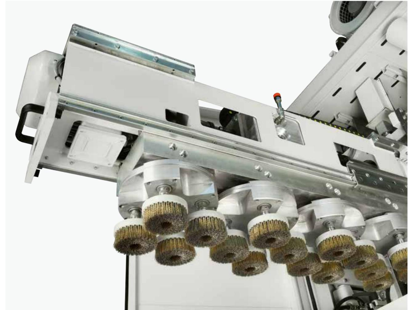
Das seit langem erprobte Schnellkupplungssystem der Bürstenscheiben ermöglicht eine schnelle Rüstung der Maschine und gewährleistet gleichzeitig maximale Zuverlässigkeit und Sicherheit der Einspannung.
