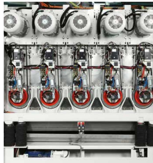
Alle elektronischen und pneumatischen Komponenten der DMC Topmetal wurden äußerst rational positioniert. Auf diese Weise ist ein umfassender Zugriff möglich und gleichzeitig kann jede Möglichkeit des Kontakts mit dem Kühlmittel ausgeschlossen werden.
