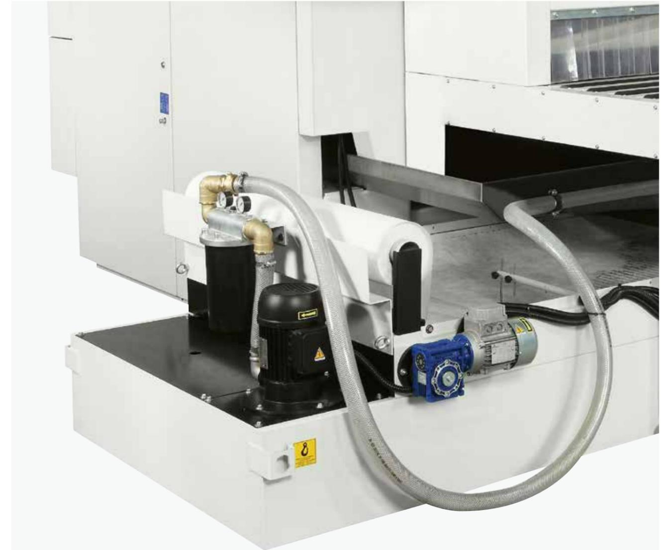
Die DMC Topmetal ist darüber hinaus mit einem Sicherheitsfilter mit Einsatz ausgestattet. Dieser verhindert, dass Bearbeitungsschnitte versehentlich in den Kreislauf gelangen, die Oberfläche der Werkstücke beschädigen und die Effizienz der Düsenbatterien beeinträchtigen. Zwei Druckmesser am Ein- und Auslauf des Filters überwachen effektiv den Zustand des Filtereinsatzes.
