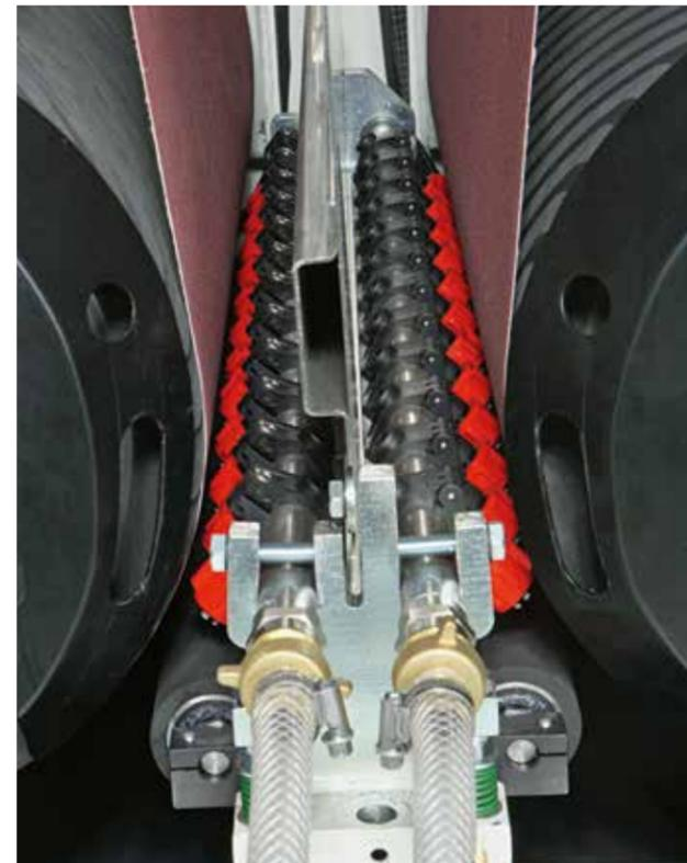
Die Kühlflüssigkeit wird über spezielle Düsenbatterien ausgegeben, die am Ein- und Auslauf jedes Arbeitsaggregats positioniert sind. Das System gewährleistet eine ordnungsgemäße Reinigung und Kühlung des Arbeitsbereichs: Damit können eine überlegene Qualität der Oberflächenbearbeitung und eine längere Lebensdauer der Schleifbänder garantiert werden.
