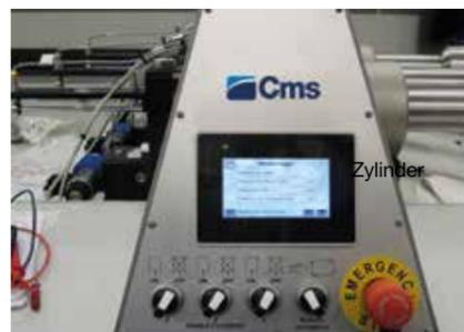
Elektronische Kontrolle des Schneidedrucks mittels Software
