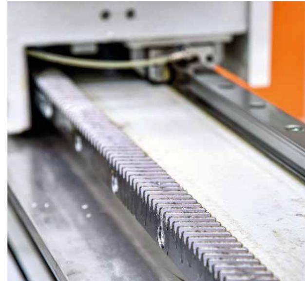
Präzisions-Paket X- und Y-Achse, Verfahren über Zahnrad und schräg verzahnten Zahnstangen für minimale Toleranzen und höchste Positionsgenauigkeit.
