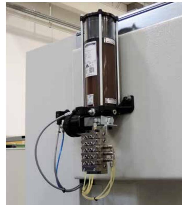
Automatische Zentralschmierung für alle Achsen
