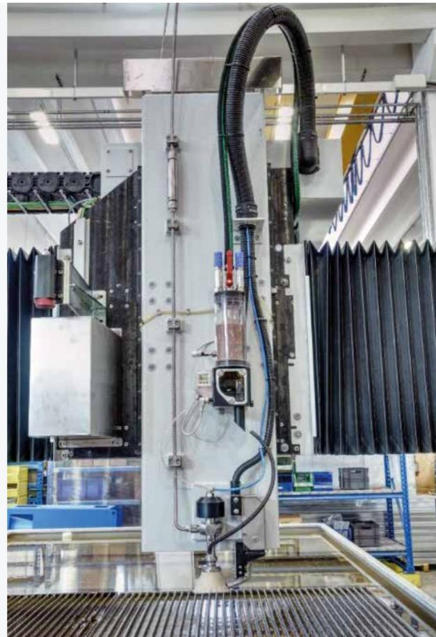
HOCHDRUCKPUMPE, MONTIERT AUF DER MASCHINENBRÜCKE. Positionierung des Servopumpe und der Hochdruckverrohrung direkt auf der X-Achse. Durch diese Bauart verringert sich die Gesamtlänge der Hochdruckverrohrung und gleichzeitig auch der damit verbundene Druckverlust pro Meter (ca. 2 Bar).
