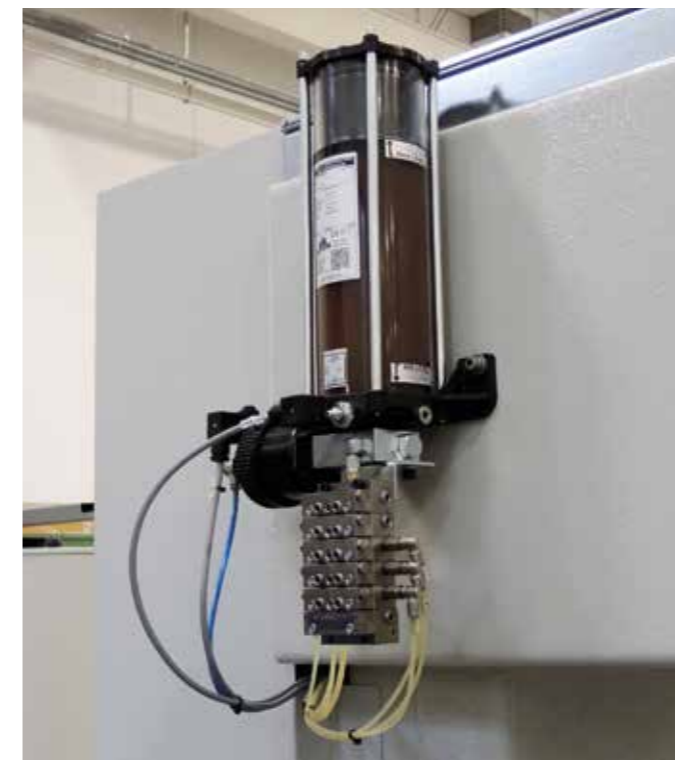
Lubrificação automática de todos os eixos (std)
