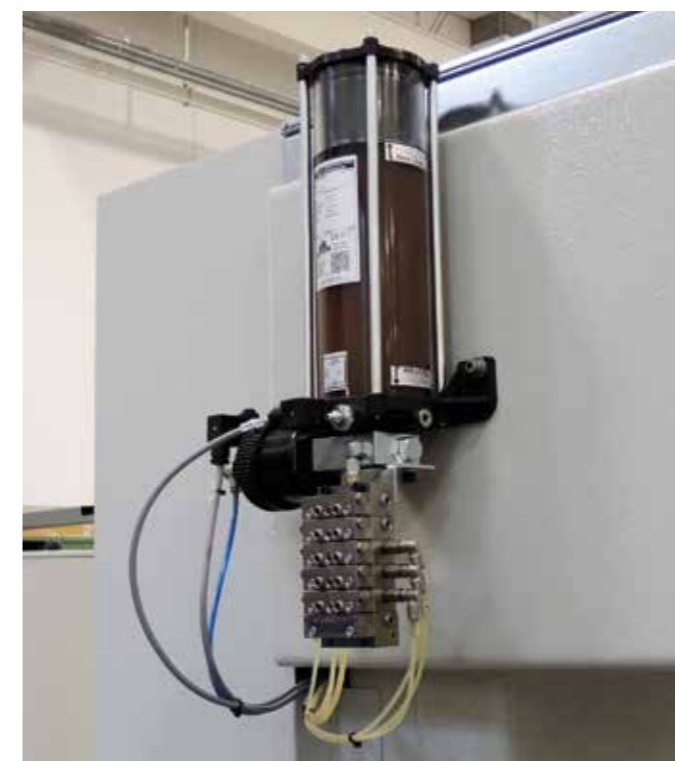
Автоматическая смазка всех осей (стандарт)
