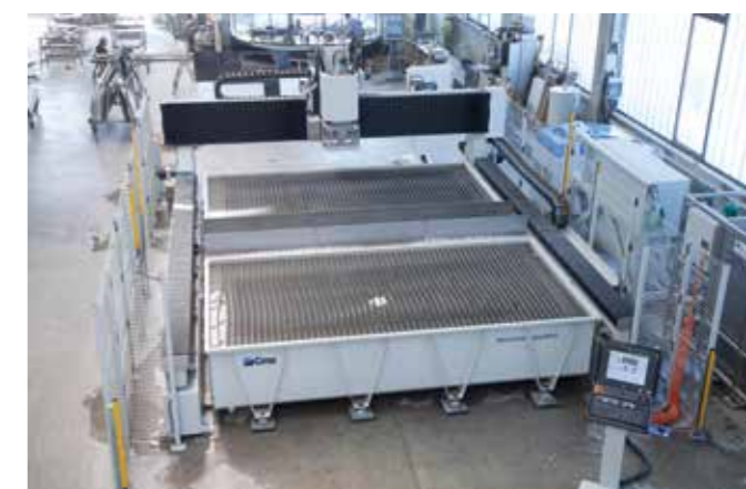
Версия с двойным баком для маятниковой обработки (опция)
