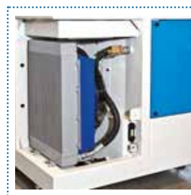
Scambiatore di calore aria/olio
