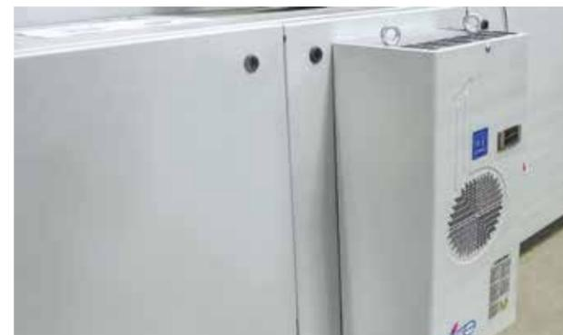
Klimaanlage für den Schaltschrank des Schneidisches für Umgebungstemperaturen zwischen 35 °C und 40 °C.
