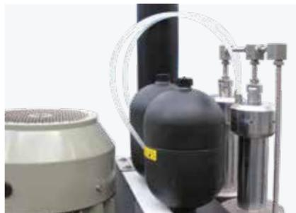
Stickstoffspeicher für die Steuerung des Rücklaufkreislaufs der Hydraulikzylinder
