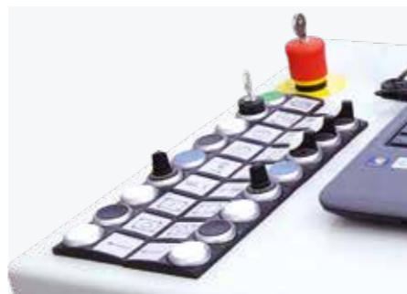
Contrôle de la pression et du fonctionnement de l'intensificateur de l'intensificateur géré directement à partir de la console
