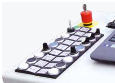
Controlo da pressão e do funcionamento do intensificador gerido diretamente pela consola.
