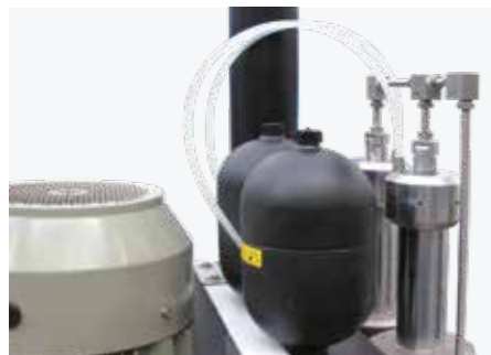
Аккумулятор азота для управления обратным контуром гидроцилиндров
