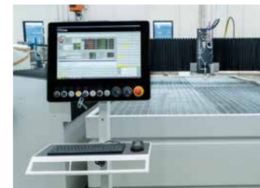
Консоль на подвижной тележке с сенсорным экраном 21,5 дюйма
