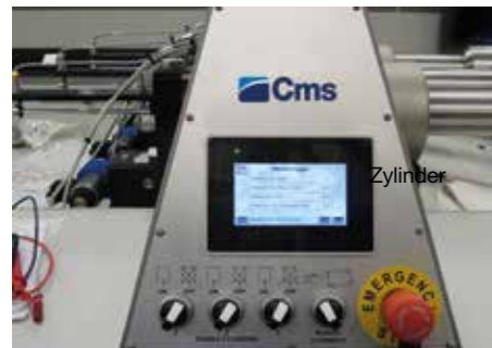
Elektronische Kontrolle des Schneidedrucks mittels Software
