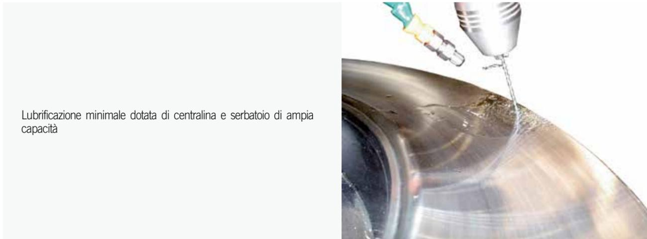
Lubrificazione minimale dotata di centralina e serbatoio di ampia capacità
