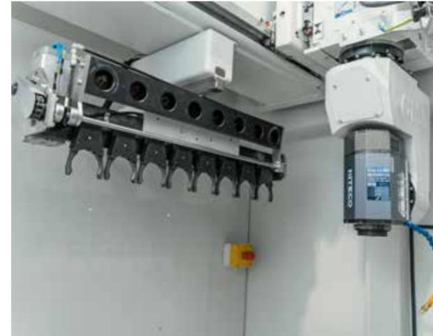
Magazzino porta utensili a 8 stazioni che consente di gestire utensili caratterizzati da peso elevato e fornisce nel contempo una protezione pressurizzata del corpo portautensile
