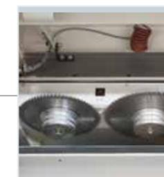
**Chariot avec lame et inciseur à élévation indépendante (en option)**
