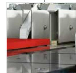
**Double pince flottante:** Préhension sûre à vitesse maximale sur le côté carré, même avec des feuilles de plastique qui ne sont pas parfaitement plates.
