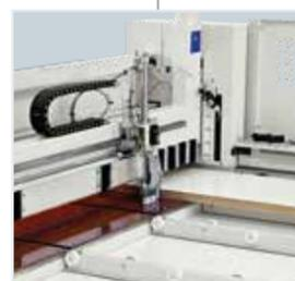
**Encostador automático: a precisão nos cortes transversais**
