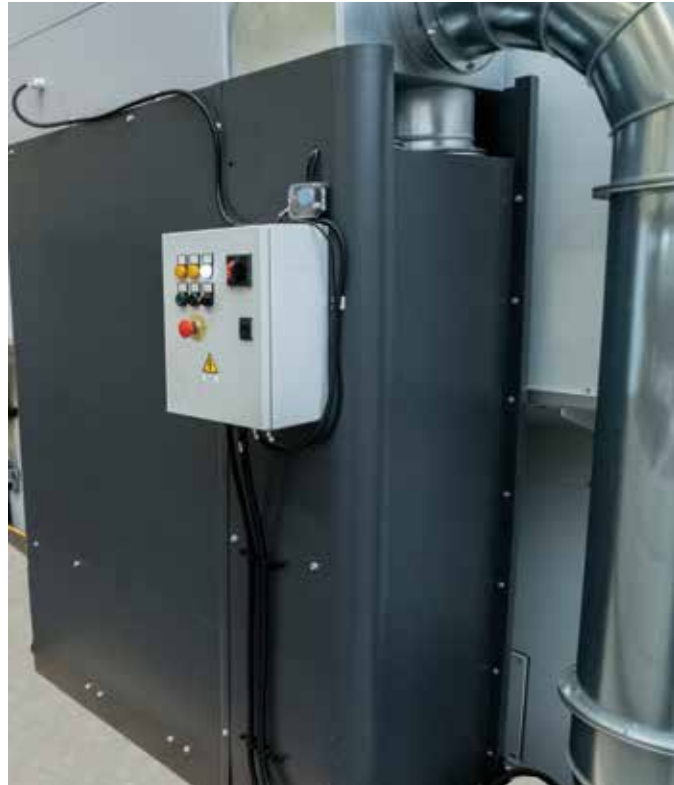
蒸汽抽吸 蒸汽抽吸系统，带绝对过滤器HEPA 99.997%，位于机器一侧。
