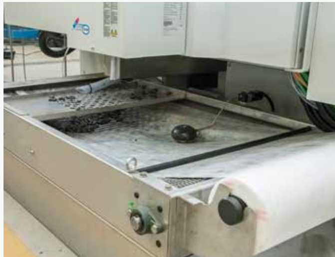
排水过滤系统 这是一个自动排放系统，将废水送至机器背部带有收集槽的滤纸处，从而将废水清洁干净。
