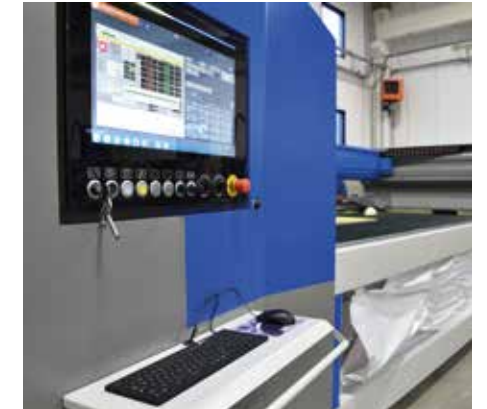
机载21.5英寸工业计算机面板，带触摸屏显示器和HMI CMS Active界面。
