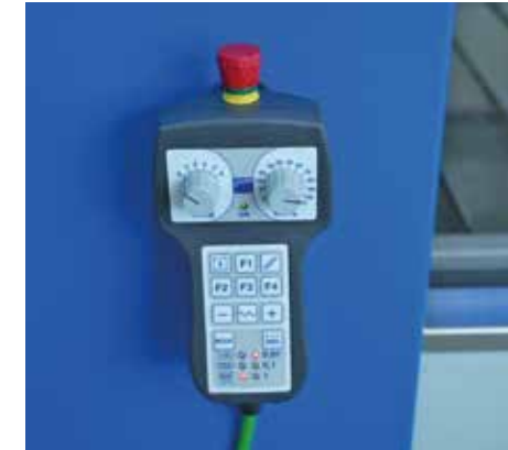
最多可控制6轴的远程按键板，允许靠近切割台操作并设置多个原点。
