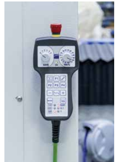
最多可控制6轴的远程按键板，允许靠近切割台操作并设置多个原点。
