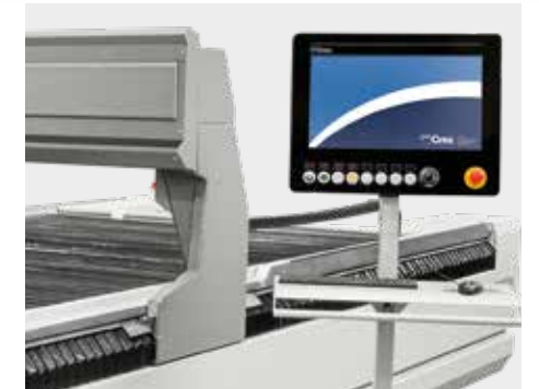
21.5英寸触屏控制台，位于活动滑架上
