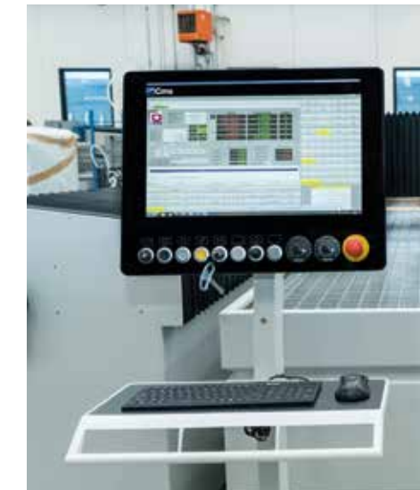
21.5英寸触屏控制台，位于活动滑架上
