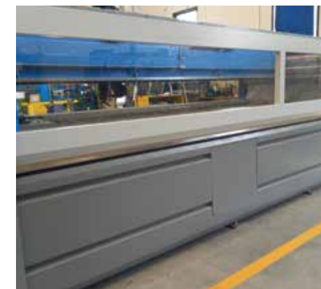
气控移动的前后门板可更好地保护切割区域并遏制水流与磨料反射。
