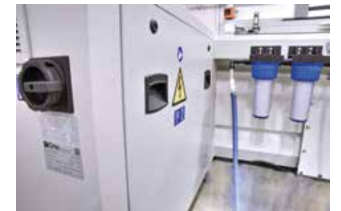
电气面板集成于槽基座，减少落地体积。
