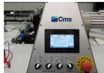
Elektronische Steuerung des Schneiddrucks
