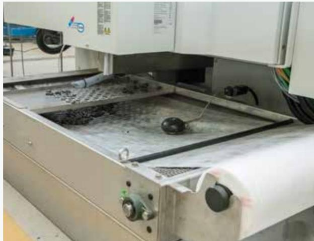
**SYSTÈME DE NETTOYAGE AUTOMATIQUE DU RÉSERVOIR**
