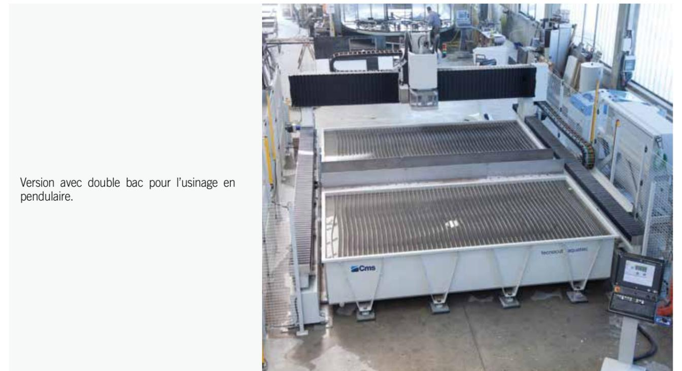
Version avec double bac pour l'usinage en pendulaire.
