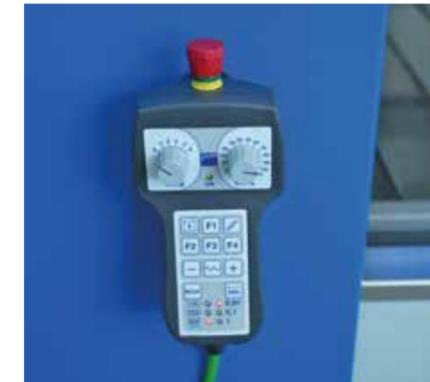
Panneau de commande à distance permettant de contrôler jusqu'à 6 axes pour travailler à proximité de la table de coupe et définir des origines multiples.
