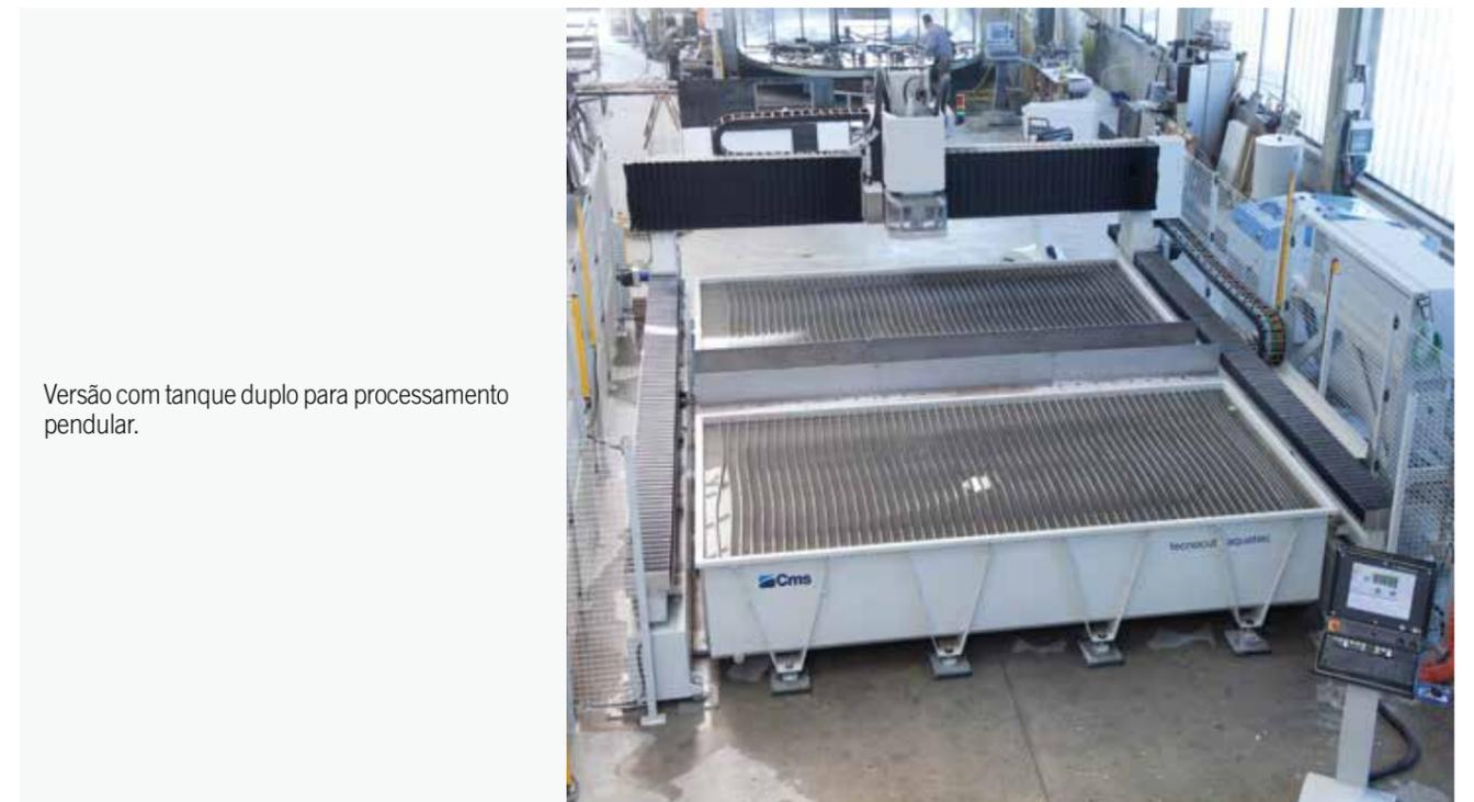
Versão com tanque duplo para processamento pendular.
