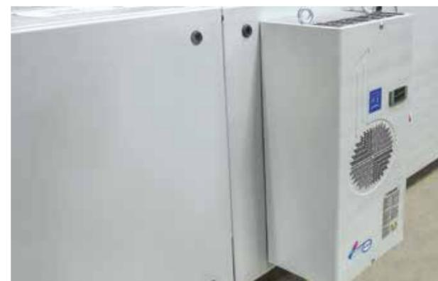
Condicionador de armário elétrico da mesa de corte para temperaturas ambiente compreendidas entre 35 °C e 40 °C.
