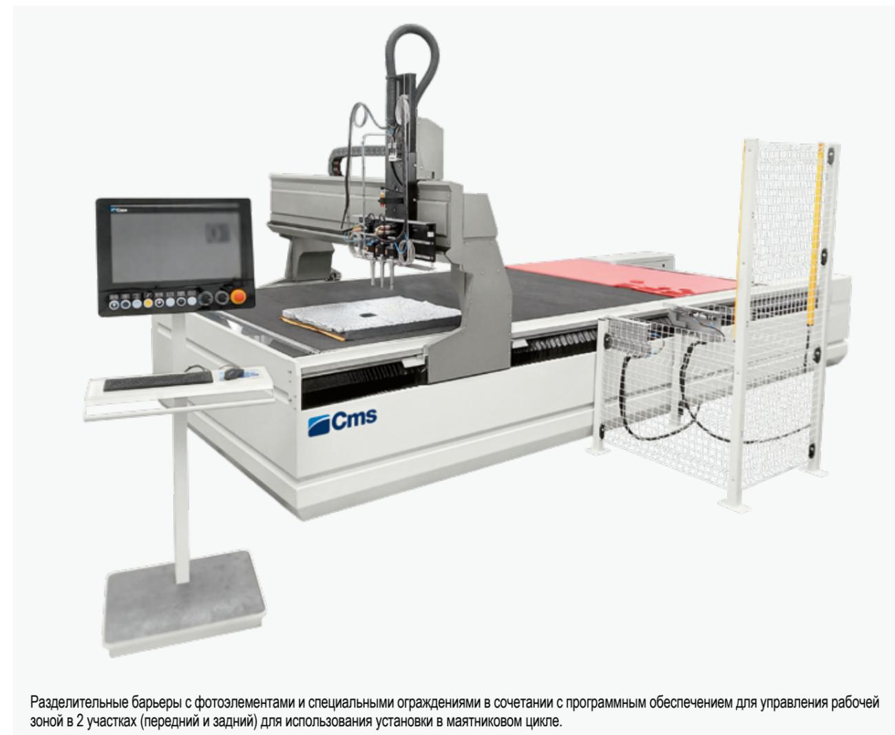
Разделительные барьеры с фотоэлементами и специальными ограждениями в сочетании с программным обеспечением для управления рабочей зоной в 2 участках (передний и задний) для использования установки в маятниковом цикле.
