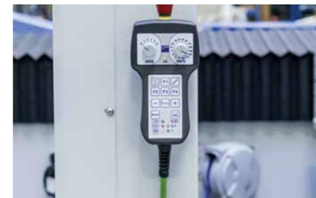
Выносной пульт для управления до 6 осями, которая позволяет работать вблизи стола резки и устанавливать несколько исходных точек.
