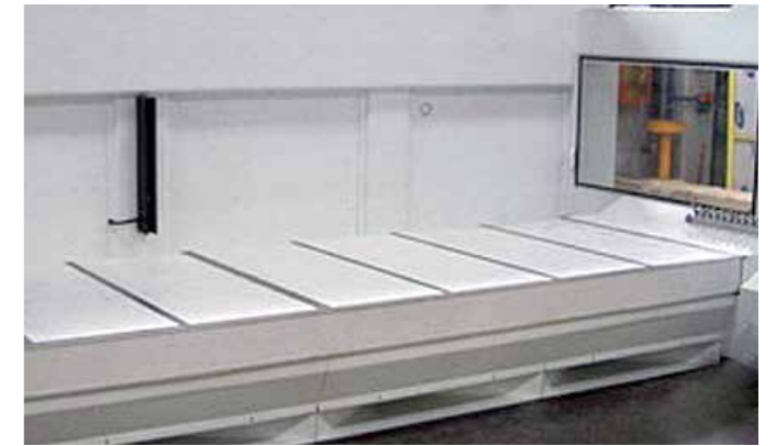
Bocche di aspirazione
