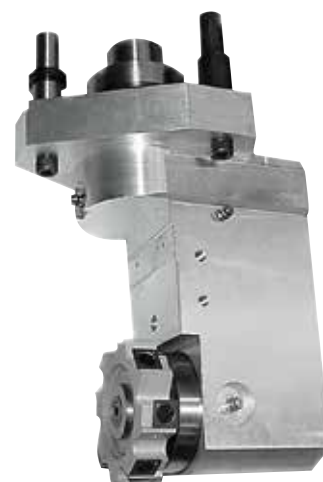
Tête pour le nettoyage d'angles internes à 90°
