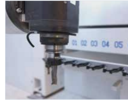
Magazine für Werkzeugwechsel mit bis zu 64 Stationen
