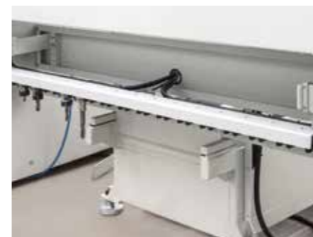
Magazin für Werkzeugwechsel mit 16 Stationen
