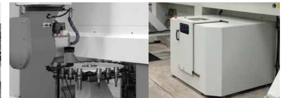
Innen- und Außenansicht Magazin für Werkzeugwechsel mit 30 Stationen
