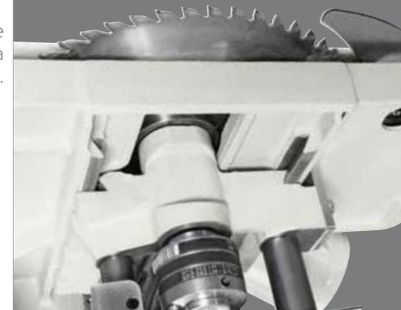
I fulcri di rotazione del corpo oscillante sono di 120 mm di diametro ed appoggiano su due lunette intermedie al basamento: soluzione rigida ed affidabile nel tempo.
