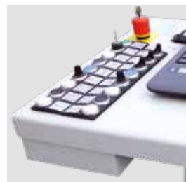
Contrôle de la pression et du fonctionnement de l'intensificateur directement géré par la console
