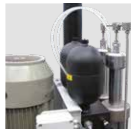
Accumulateur à membrane d'azote pour la gestion du circuit de retour des cylindres hydrauliques
