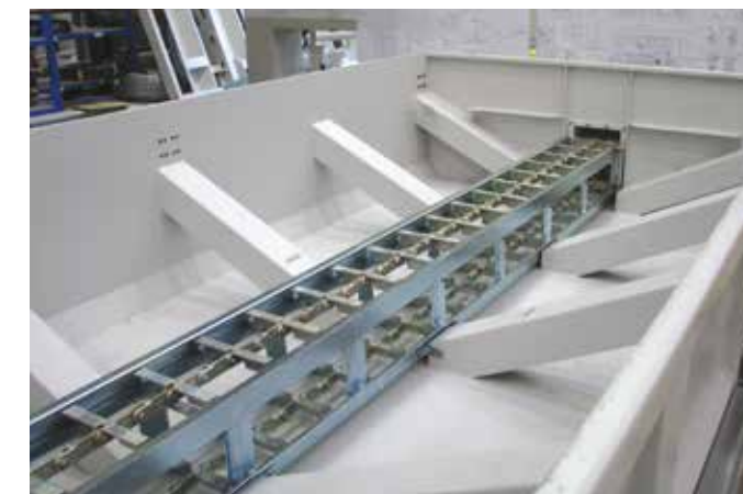
Système de dragage "no maintenance" pour le retrait automatique des déchets abrasifs. Le système d'évacuation à l'intérieur des vasques, est protégé par des tambours pour récolter les déchets d'usinage et par une cage métallique. La vasque peut être équipée du système de dragage dans un second temps (option)
