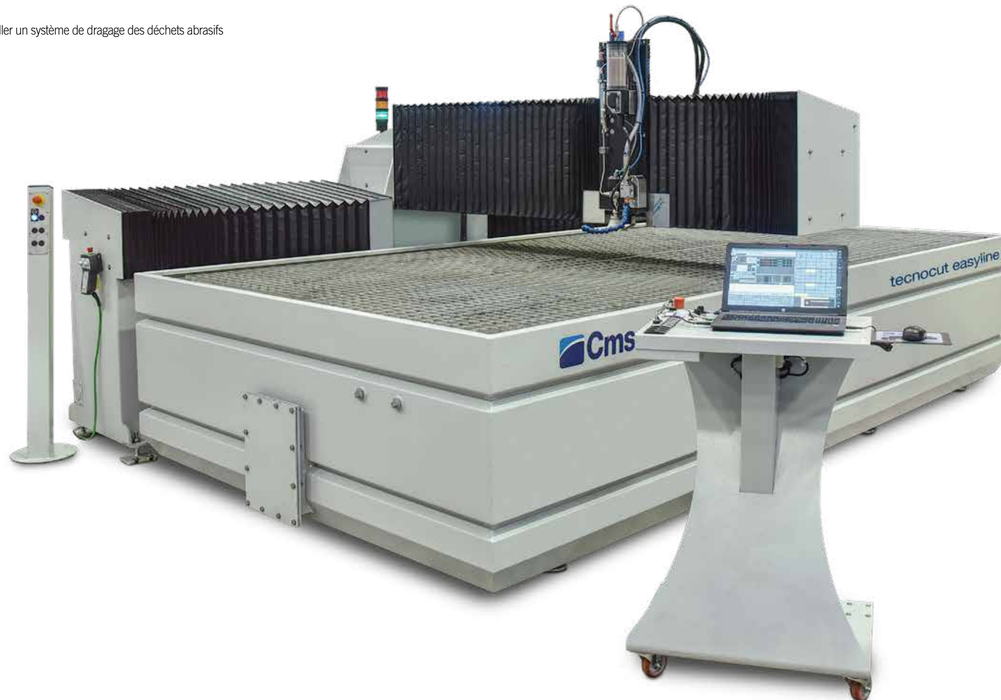
Console: panneau de contrôle mobile avec laptop
