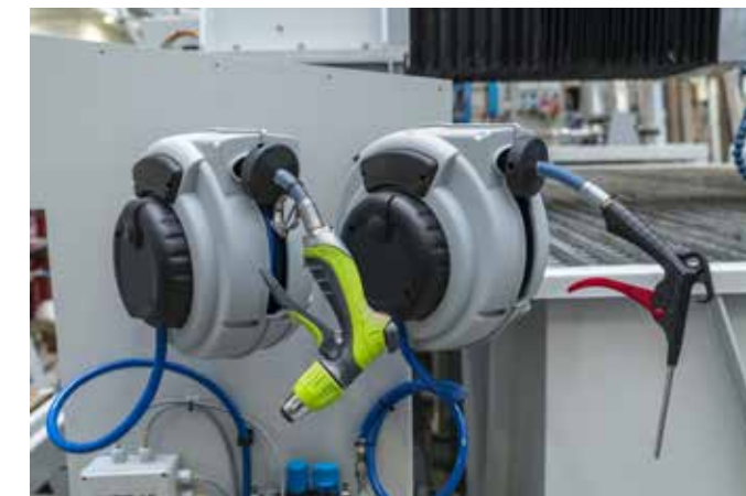
ENROULEUR DE TUYAU AUTOMATIQUE Kit de pulvérisateurs d'air et eau pour nettoyer la table et le matériel en fin de coupe (option)
