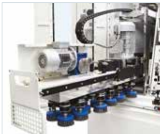
Groupe Planétaire: ponçage multi-directionnel pour une finition d'excellente qualité.
