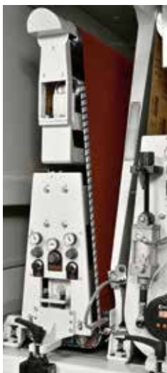
Groupe superfinisseur avec un développement de la bande de 2620 mm.
