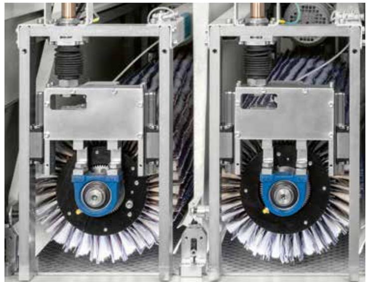
**Positionnement automatique** du groupe brosses pour une mise en place facilitée et un changement plus rapide du programme d'usinage.
