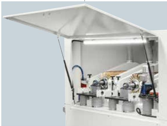
*Liberté de mouvement maximale grâce à l'ouverture verticale à vérins et au micro-interrupteur de sécurité.*
