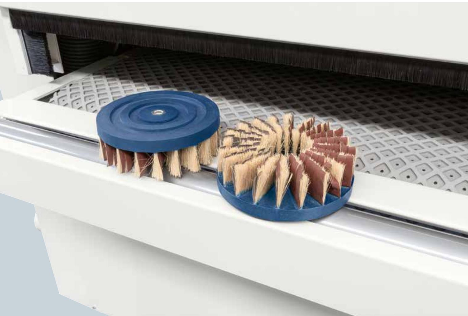
**Mouvement à translation** grâce à un moteur indépendant pour **une efficacité supérieure sur les angles**.
