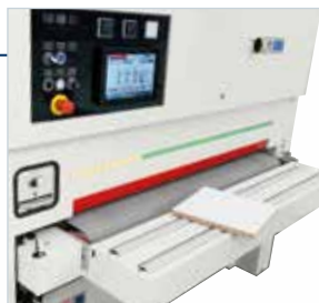
Séquenceur pour l'introduction du panneau afin de réduire les coûts de gestion de la machine.
