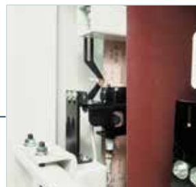
Photocellule pour l'oscillation des bandes pour une plus grande durée de vie de la bande.
