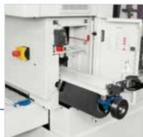
Groupe de brosses interchangeable en sortie du plan de travail pour une haute flexibilité d'usinage.
