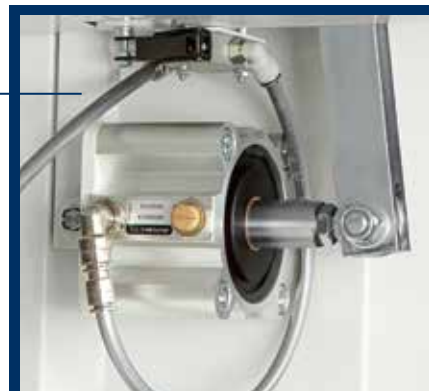
Dispositif automatique pour le centrage du tapis pour une plus grande durée de vie de la bande de transport.
