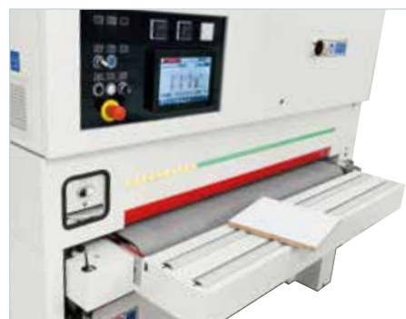
Séquenceur pour l'introduction des panneaux afin de réduire les coûts de gestion de la machine.
