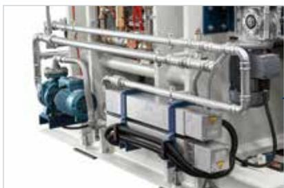
*Sistema di riscaldamento indipendente per il piano inferiore e superiore della macchina con boiler ad olio diatermico, consente la regolazione della temperatura a seconda della lavorazione che dev'essere eseguita.*
