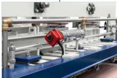
*Due scambiatori di calore elettrici per il riscaldamento dell'aria pressurizzata, alimentati con energia elettrica per migliorare la qualità di incollaggio.*
