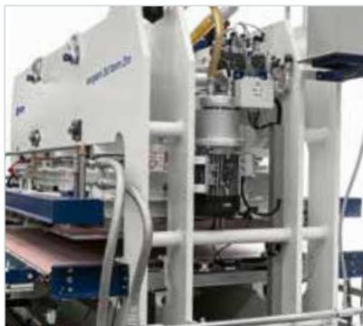
*Struttura in lamiere d'acciaio di grosso spessore per garantire maggiore rigidità e affidabilità della struttura anche a elevate pressioni di lavoro, per una migliore qualità del prodotto pressato.*
